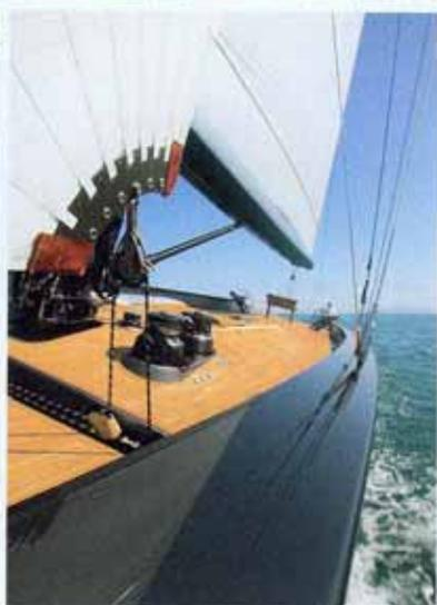
Strecker aus dem Mast direkt auf die Trommeln der Winschen. Umlenkrollen verbinden sie kraftschlüssig mit dem Mast und entlasten so das Deck von Mastkräften. „Die Winschen sind auch zuständig für den Castoldi-Tender“, erklärt Kapitän Lottini. „Wir bringen ihn mit einem Fall zu Wasser.“
